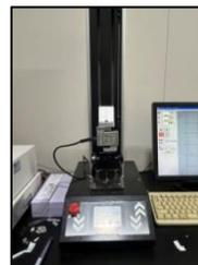
(図5: 卓上型引張圧縮試験機)
